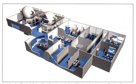
Auf der Grafik sind links die «Kugeln» mit den Missionssimulatoren für den Eurofighter und davor der kleinere Cockpittrainer zu sehen. In der Mitte überwachen und steuern die Instruktoren das Training. Diese Einrichtungen, zusammen mit den Computern und Debriefungsräumen, sind in einem besonderen Gebäude untergebracht.
