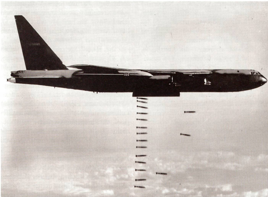
Eine B-52D wirft ihre Bombenlast über einem Ziel in Nordvietnam ab. Diese Version der B-52 konnte 66 bis 108 Bomben der Typen Mk 117 und Mk 82 mitführen.
