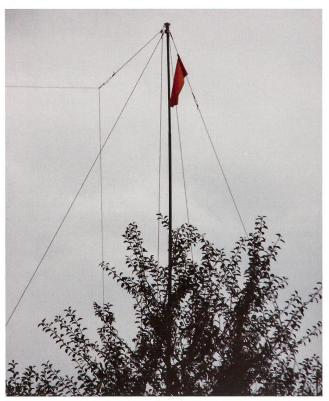
Die Breitband-Antenne BBA, gesichert durch das Fähnchen.
