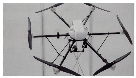
Die deutsche Firma AirRobot GmbH stellt diese Kleindrohne AR100-B her. Sie wiegt 1,3 Kilogramm, hat eine Reichweite von 1000 Metern und wird von Elektromotoren angetrieben. Die Einsatzzeit beträgt ca. 25 Minuten. Als Nutzlast kommen je nach Auftrag verschiedenste Kameras zum Einsatz.
