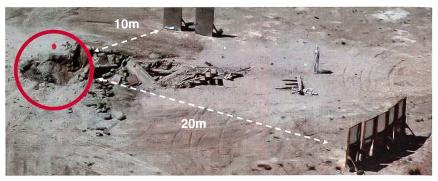
Das Bild ist zwar unscharf, dafür sehr aussagekräftig. Diese Illustration betrifft das Mittlere Artillerie-Raketen-System (MARS), englisch genannt Ground Missile Launch Rocket System (GMLRS). Der rote Kreis links im Bild bezeichnet das Ziel. Sichtbar sind in Form eines kleinen Kraters die Einschläge im Ziel. In der Distanz von 10 und 20 Metern vom Ziel weisen Stahlplatten keine Splitterdurchschläge auf.
