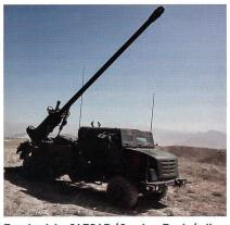
Frankreich: CAESAR (Camion Equipé d'un Système d'Artillerie). Kaliber 155 mm. Rohrlänge 52 Kaliber. Gewicht 18 t. Distanz 55 km. 6 Schuss/min. Wirkungsbereich je 17 Grad. Munitionsvorrat 18 Geschosse. Bedienung vier Mann.
