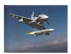
Soeben ist eine Meteor-Luft-Luft-Lenkwaffe von einem Kampfflugzeug abgeschossen worden.
