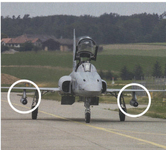
F-5 mit zwei EKUR-Sammelaggregaten an den Flügelstationen.
