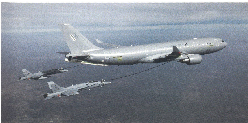
Ein Airbus KC-45 versorgt zwei F-18 Kampfflugzeuge. Mit dem digitalen 905E Auf-tanksystem können pro Minute rund 1700 Liter Treibstoff abgegeben werden.
