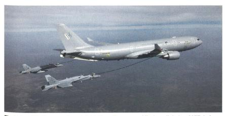
Ein Airbus KC-45 versorgt zwei F-18 Kampfflugzeuge. Mit dem digitalen 905E Auftanksystem können pro Minute rund 1700 Liter Treibstoff abgegeben werden.
