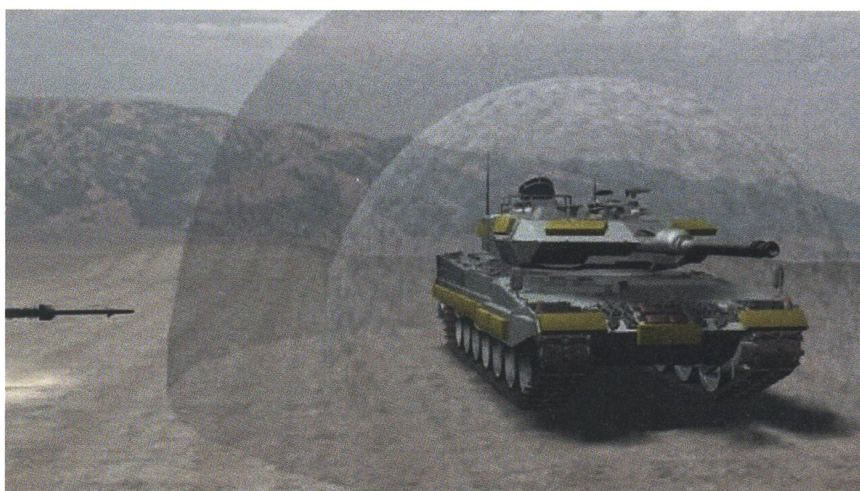
Die Funktion von ADS: Links sichtbar ist ein Geschoss. Auf der äusseren Halbkugel wird das Geschoss erfasst und bei der inneren Halbkugel unschädlich gemacht.
