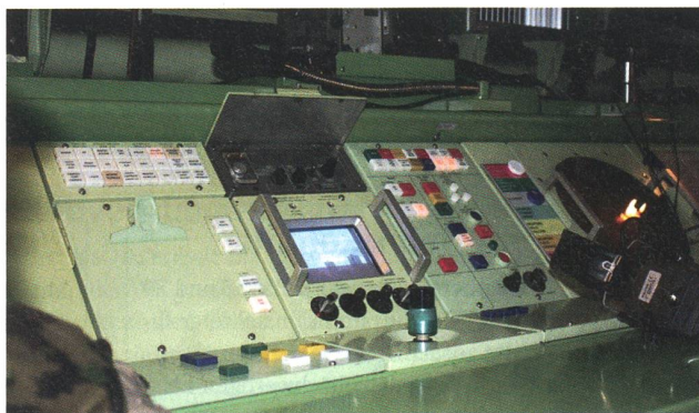
Ein Blick in das Innere des Feuerleitgerätes 75/10 mit den komfortablen Bedienungseinrichtungen. Mit der Erneuerung im Jahr 2010 kamen das Infrarot und ein Zusatzrechner hinzu.
