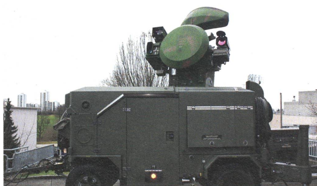
Lange trug das Feuerleitgerät die Nummer 75/95. Jetzt heisst es Feuerleitgerät 75/10, weil im Jahr 2010 zusätzlich das Infrarot montiert wurde (rechts schwarz/violett gut erkennbar).
