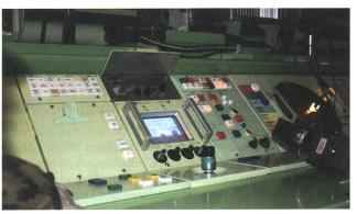
Ein Blick in das Innere des Feuerleitgerätes 75/10 mit den komfortablen Bedienungseinrichtungen. Mit der Erneuerung im Jahr 2010 kamen das Infrarot und ein Zusatzrechner hinzu.
