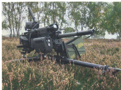
Der automatische 40 mm Granatwerfer «C-16 Automatic Grenade Launcher System», ausgerüstet mit der Feuerleittechnik der Rheinmetall Tochter Simrad Optonics.
