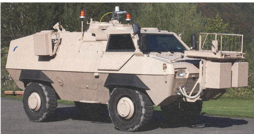
Deutlich sichtbar sind auf dem Bild die für den Laser notwendigen Aufbauten.
