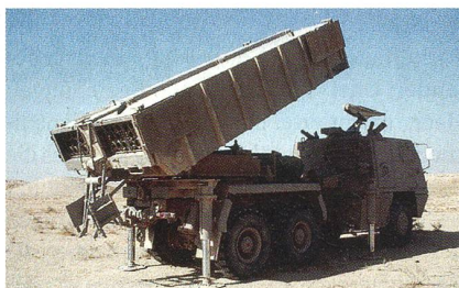
Avibras-ASTROS-II-SS-30-Mehrfachraketenwerfer auf Tectran-6x6-AV-LMU-Geländelastwagen.
