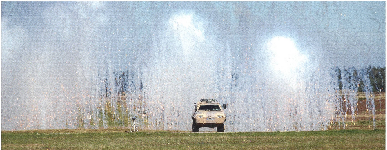
Das Vernebelungssystem ROSY bietet dem Schützenpanzer innert weniger Sekunden Schutz gegen Beschuss.
