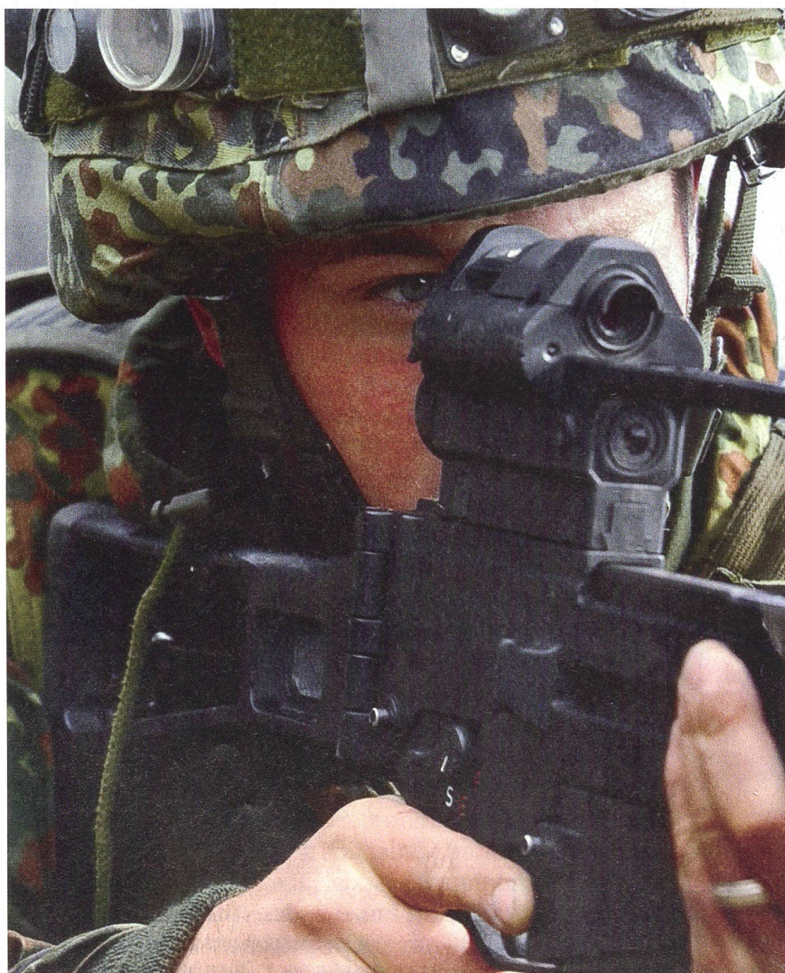
An Helm und Gewehr trägt Krämer den «Duellsimulator». Die Sensoren verraten, ob er bei der Übung von einem Lasersignal getroffen wurde.
