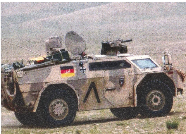
Fennek Boden/Boden, Fahrzeug für Joint Fire Support Team mit einem Beobachtungsoffizier, einem Beobachtungsfeldwebel und einem Fahrer. Lenkung des Feuers von bodengebundenen Wirkmitteln, von Kampfhelikoptern und Seestreitkräften.
