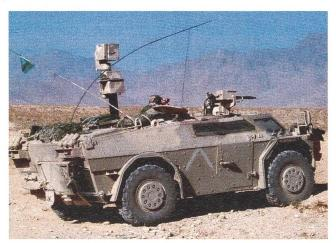
Fennek Luft/Boden, Fahrzeug für Joint Fire Support Team mit einem Fliegerleitoffizier, einem Fliegerleitunterstützungsfeldwebel, einem Fahrer. Lenkung des Feuers luftgestützter Wirkmittel für Luftnahunterstützung (Close Air Support).
