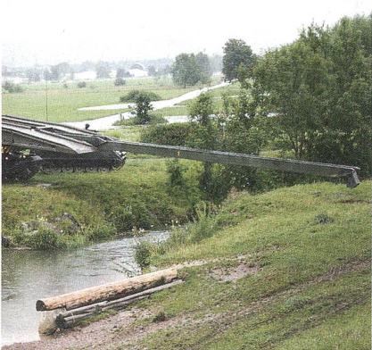
Der Brückenpanzer fährt den Arm aus.
