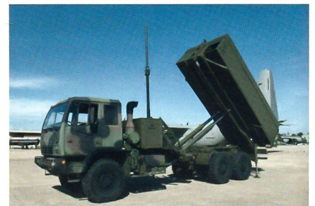
Startereinheit MEADS auf Geländelastwagen.
