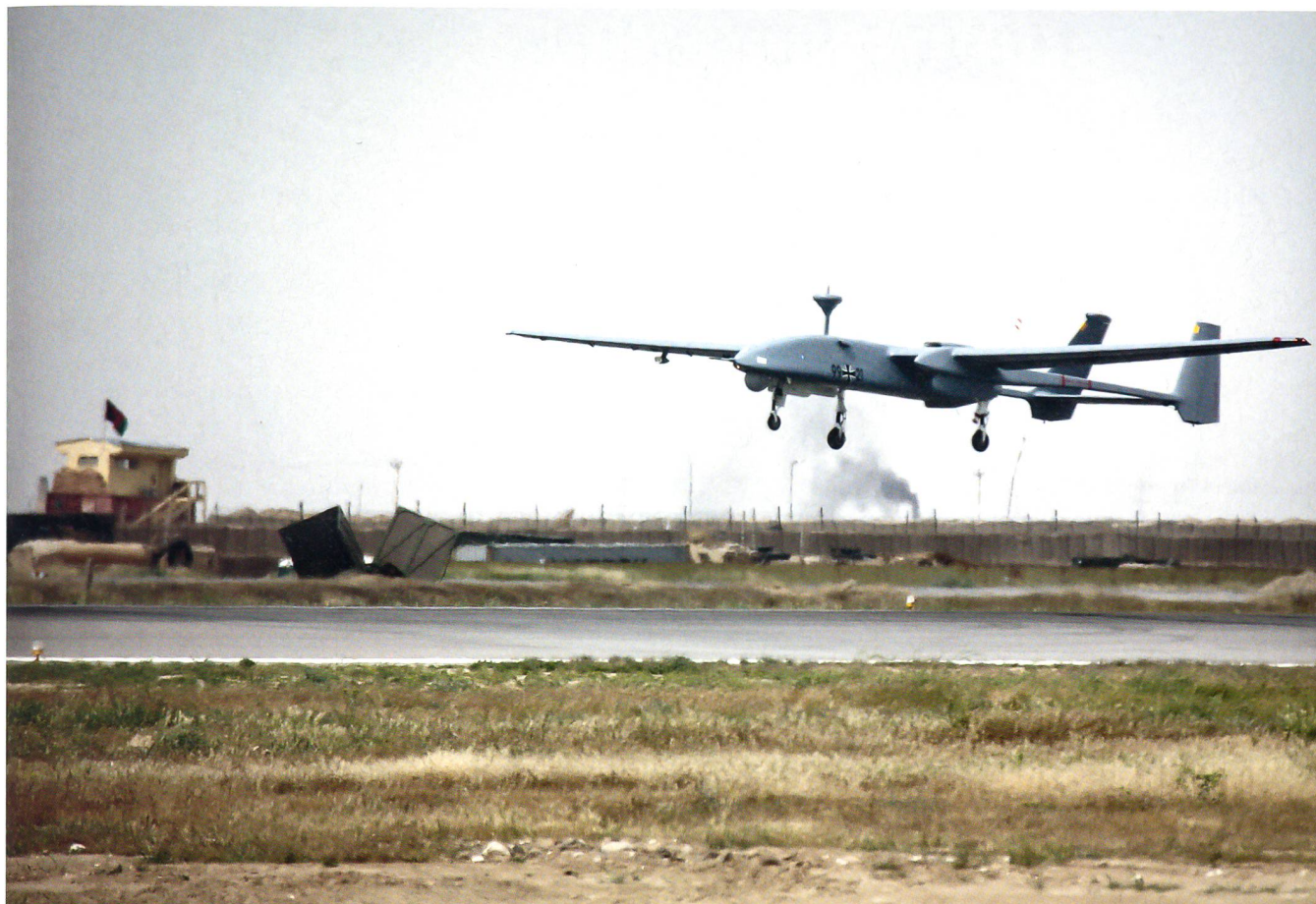
Die Drohne hat eine Flügelspannweite von 16,6 Metern, ein Startgewicht von 1200 Kilogramm, eine Nutzlast von 250 Kilogramm, operiert bis in eine Höhe von knapp 10 000 Metern und ist in der Lage über 30 Stunden zu fliegen.
