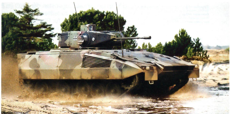
Der deutsche Schützenpanzer Puma mit drei Mann Besatzung und sechs Grenadieren und einem maximalen Gewicht von 43 Tonnen, je nach Schutzstufe, bildet möglicherweise die Basis für das neue Ground Combat Vehicle der US-Armee.
