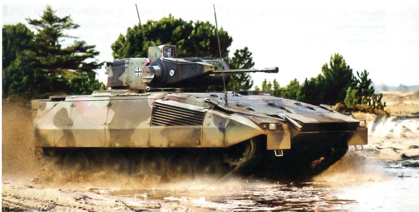
Der deutsche Schützenpanzer Puma mit drei Mann Besatzung und sechs Grenadiere und einem maximalen Gewicht von 43 Tonnen, je nach Schutzstufe, bildet möglicherweise die Basis für das neue Ground Combat Vehicle der US-Armee.
