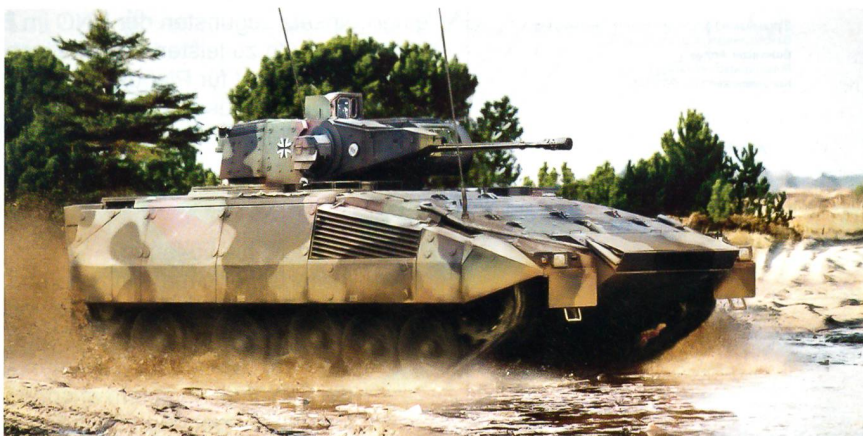
Der deutsche Schützenpanzer Puma mit drei Mann Besatzung und sechs Granadiere und einem maximalen Gewicht von 43 Tonnen, je nach Schutzstufe, bildet möglicherweise die Basis für das neue Ground Combat Vehicle der US-Armee.
