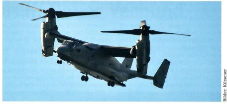
Das neueste Lufttransportmittel der Marines ist die Osprey MV-22, ein Schwenkflügler, der wie ein Helikopter vertikal startet und landet, sich dann aber wie ein normales Propellerflugzeug vorwärts bewegt. Diese Maschinen ersetzen die gut 40-jährigen CH-46 Sea Knight Tandemrotor Helikopter.
