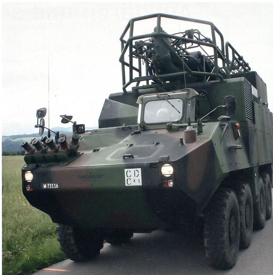
Mobiler Effektor der EKF Stufe Armee: Mehrzwecksender SE-630, Piranha IIIC 8x8 mit eingefahrener Antenne. Gewicht 22 t; Breite 2,73 m; Gesamtlänge 9,2 m; Höhe sendebereit 19,6 m; Leistung 350 PS; Reichweite 500 km; Geschwindigkeit: 80 km/h.
