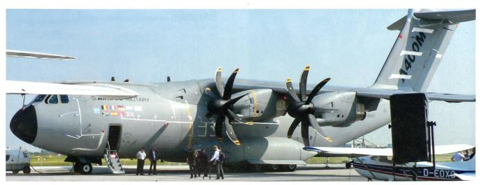
Der A400M mit seinen auffallend grossen Propellerblättern. Die Turbinen drehen nicht alle in der gleichen Richtung. Pro Seite dreht ein Triebwerk in der Gegenrichtung. Diese Lösung musste gewählt werden, damit die Struktur der Maschine die enormen Kräfte der Triebwerke aushält.
