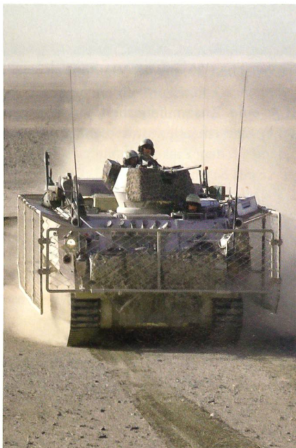
Ein M 113 der dänischen Armee, ausgerüstet mit dem LASSO-Schutzsystem der RUAG Land Systems, in Afghanistan im Einsatz.
