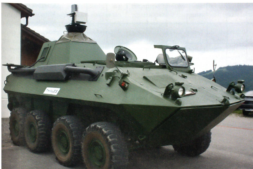
Als Unterbau dient ein alter Piranha-2 8x8 der Firma MOWAG.
