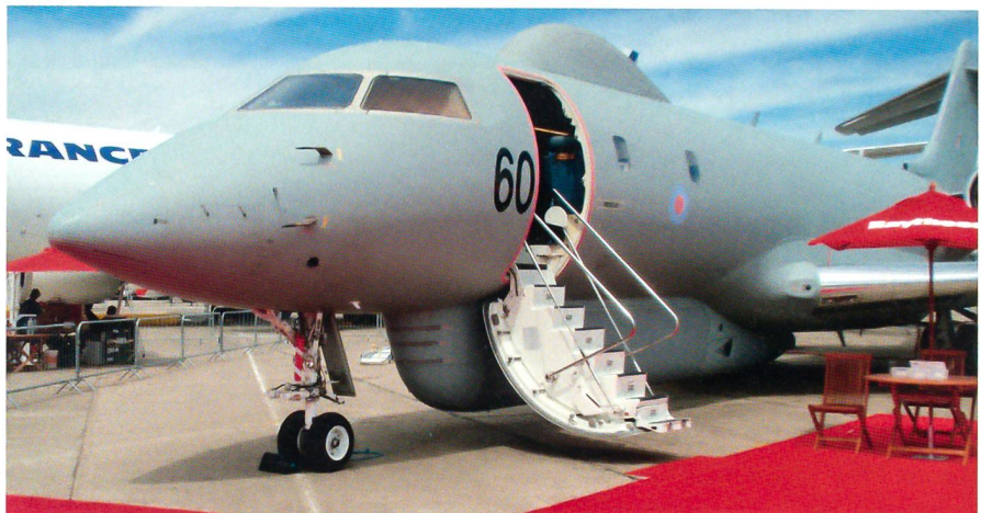
Ein modifizierter Business-Jet vom Typ Global Express in den Farben der Royal Air Force wird mit dem Führungs- und Aufklärungssystem BACN (unter dem Rumpf gut erkennbar) kombiniert.
