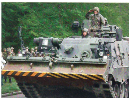
Der mächtige Bergepanzer Büffel auf dem Chassis des Kampfpanzers Leopard.
