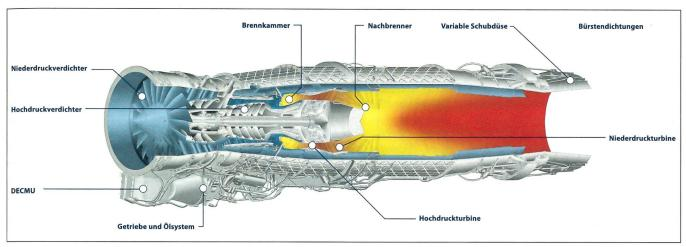
Die Darstellung zeigt die Funktionsweise des Eurofighter-Triebwerks mit den Bezeichnungen der verschiedenen Funktionen.
