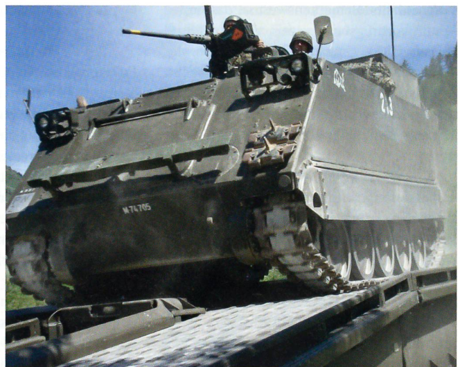
Der Schützenpanzer stösst über ein Brückenelement.
