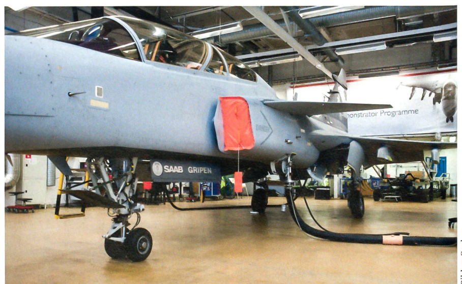
Flügelwurzel mit erweiterten Treibstofftanks sowie neue Fahrwerksanordnung beim Gripen Demonstrator.
