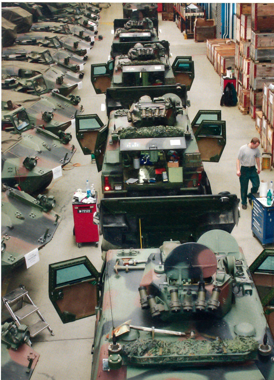
Der Blick in die Montagehalle im Spidertown Tägerwilen. In langen Strassen wird fünf verschiedenen Radfahrzeug-Typen das Führungsinformationssystem Heer eingebaut.
