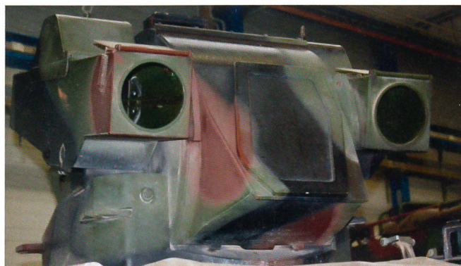
Fast schon ein nostalgisches Bild. Mit diesem Aufbau kommt der Panzerjäger 6x6, ein Piranha-1, nach Tägerwilen. Die gefürchtete Waffe des Panzerjägers ist im Ansatz gut zu erkennen: Die Panzerabwehr-Rakete TOW mit den beiden Röhren.
