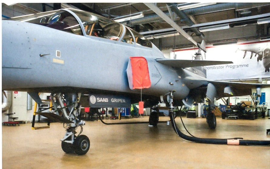
Flügelwurzel mit erweiterten Treibstofftanks sowie neue Fahrwerksanordnung beim Gripen Demonstrator.
