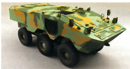
Systemstudie des 6x6-Radschützenpanzers VBTP-MR.
