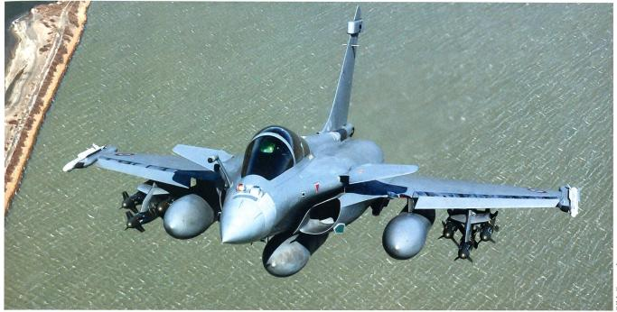
Das französische Kampfflugzeug Rafale, ausgerüstet mit sechs modernen Luft-Boden-Lenkwaffen des Typs AASM: Armament Air-Sol Modulaire. Sie werden seit über einem Jahr in Afghanistan erfolgreich eingesetzt.
