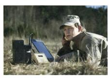
Soldat betreibt Funkgerät mit einer Brennstoffzelle.
