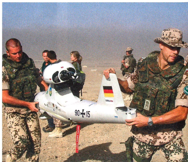
Die Handhabung ist einfach. Das Startgewicht beträgt 40 kg und die Drohne hat eine Betriebszeit von bis zu fünf Stunden.
