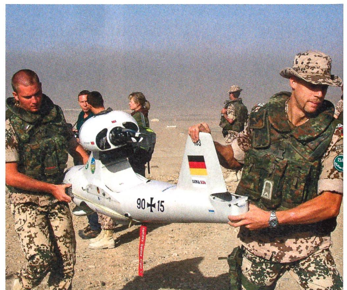
Die Handhabung ist einfach. Das Startgewicht beträgt 40 kg und die Drohne hat eine Betriebszeit von bis zu fünf Stunden.
