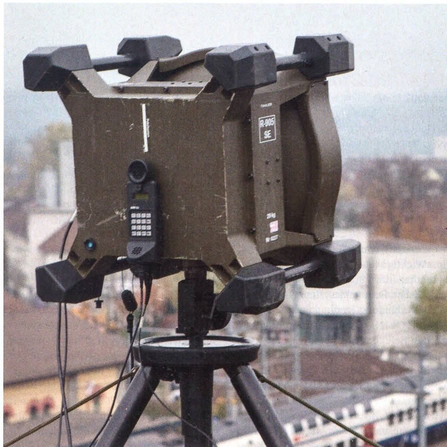
Im Kern jeder Operation: Das moderne, robuste Richtstrahlgerät R-905.
