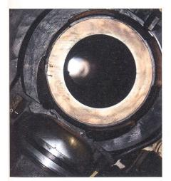
Blick durchs Rohr der Panzerhaubitze. Das Kaliber beträgt 155 Millimeter.
