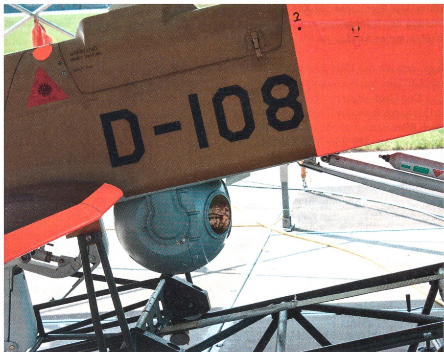
Die Aufklärungsdrohne ADS 95, gut erkennbar die runde Hochleistungskamera.
