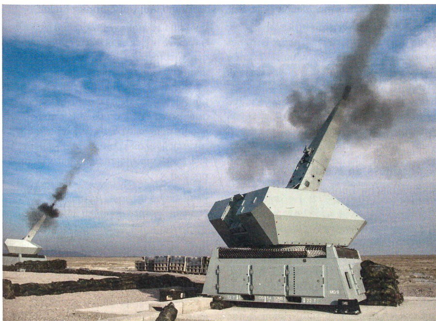
Zwei Geschütze des Systems NBS C-RAM beim Bekämpfen von un gelenkten Raketen. Verschossen wird die programmierte Ahead-Munition, welche die Zerstörung der anfliegenden Flugkörper in der Luft erlaubt.
