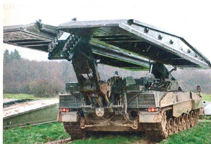
Doppelbrückensystem Leguan auf Leopard 2.
