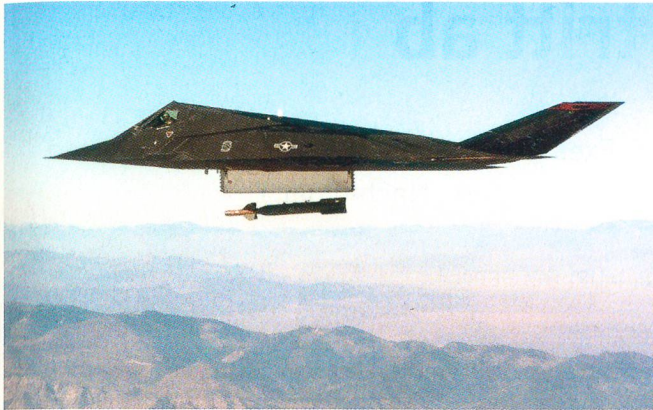
Einmaliges Dokument in zwei Bildern: Abwurf einer Freifall-Lenkbombe aus dem Waffenschacht einer F-117.
