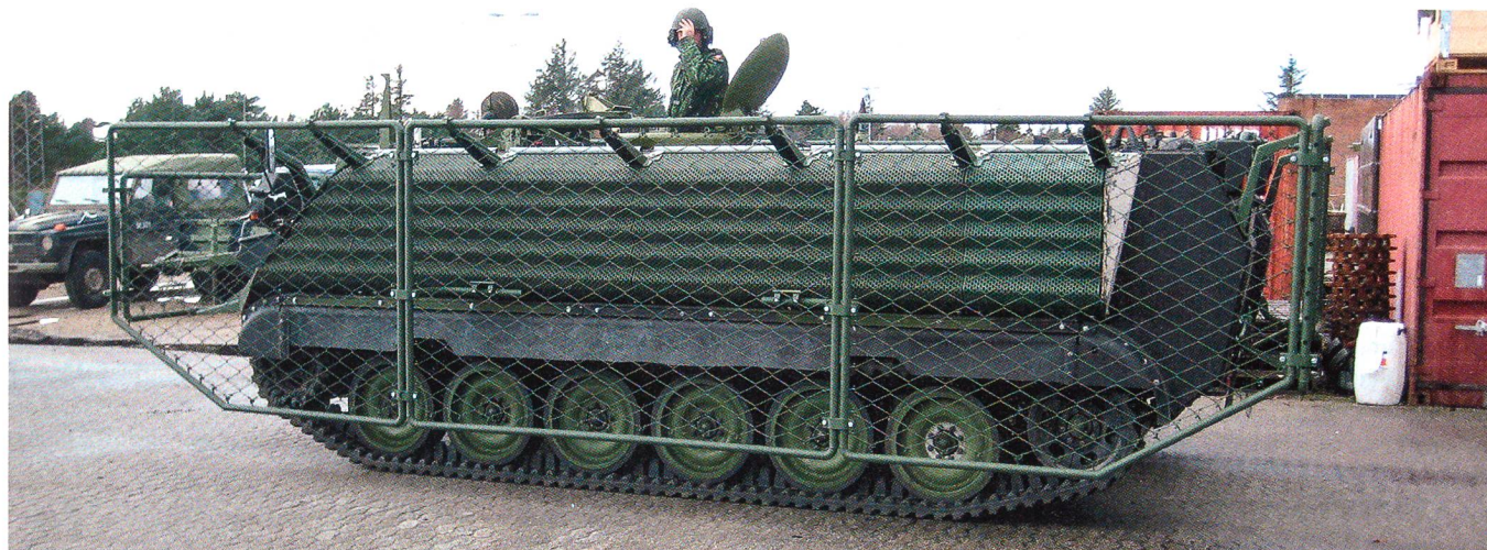
Gut sichtbar sind die am Schützenpanzer M-113 angebrachten Drahtgitter, welche einen guten Schutz gegen den Beschuss mit Panzerabwehrwaffen bieten.
