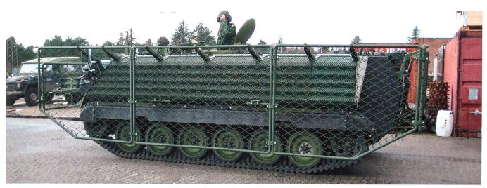
Gut sichtbar sind die am Schützenpanzer M-113 angebrachten Drahtgitter, welche einen guten Schutz gegen den Beschuss mit Panzerabwehrwaffen bieten.
