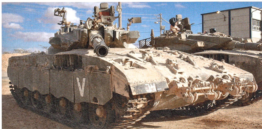
Seitenansicht des Merkava II an der Panzertruppenschule. An der Wanne befindet sich die Aufnahme für Pioniergerät. Seitlich sind die Nebelwurfbecher IMI CL-3030 verbaut.
