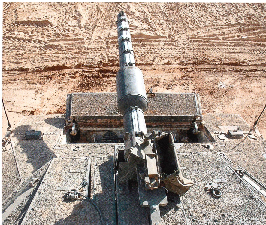
Über der 120-mm-Kanone kann ein .50-cal-Maschinengewehr für den Kampf in urbanisiertem Gebiet verbaut werden. Man beachte dazu rechts den Hülsenfang für die 12,7 mm x 99 Patronen. Vorne befindet sich die geöffnete Motorabdeckung.
