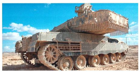
Seitenansicht des Merkava IV mit gedrehtem Turm. Viele Details wie zum Beispiel die «Ball-and-Chain»-Schutzketten an der Turmunterseite können so erkannt werden.
