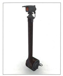
«Die Stange» mit Kamera und Mikrofon besteht aus Karbon.
