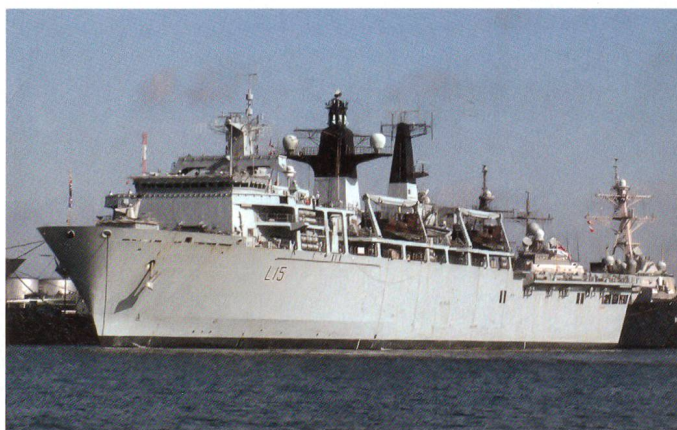
Die Royal Navy entsandte das 18560 Tonnen grosse amphibische Landungsschiff «HMS Bulwark» nach Kiel. Es kann 400 Marinefüsiliere, vier Landungsboote sowie Hubschrauber aufnehmen.
