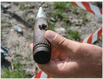
Blindgänger-Vernichtung: 35 mm Flab-Geschoss (inert) beschossen mit KMB Ldg 33 mm.
