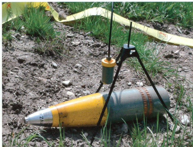
Blindgänger-Vernichtung: KMB Ldg 33 mm über einer 10,5 cm Kan/Hb-Stahlgranate.
