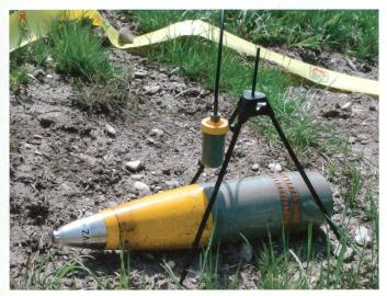
Blindgänger-Vernichtung: KMB Ldg 33 mm über einer 10,5 cm Kan/Hb-Stahlgranate.
