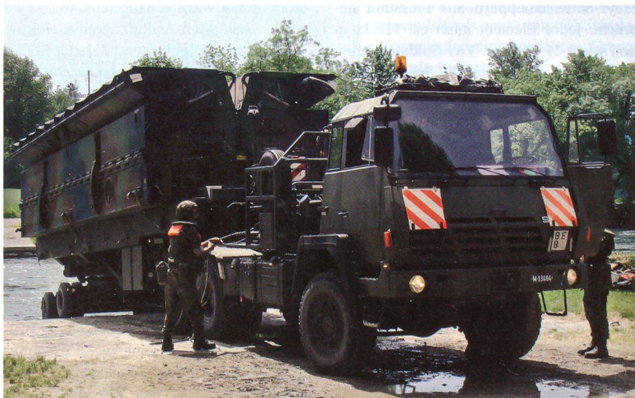
Das erste Element der Schwimmbrücke wird in die Aare gelassen.
