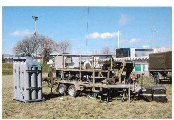
Bodenstation Fesselballon mit Winde und Gasflaschen.
