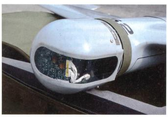
Modulare Sensoreinheit am Kopf der Minidrohne.
