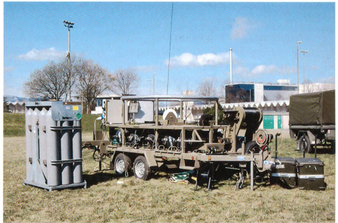
Bodenstation Fesselballon mit Winde und Gasflaschen.
