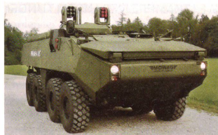
Piranha IIIC mit Saab LEDS 150 Mongoose.
