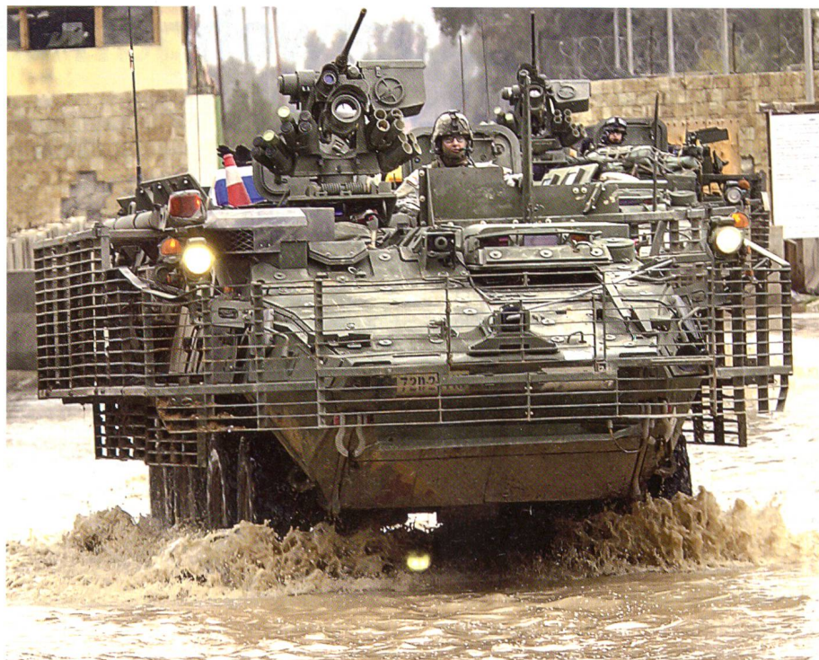
Ein Teil der von der amerikanischen Army im Irak eingesetzten Piranhas ist mit zusätzlichen Schutzvorrichtungen versehen. Sie machen die Fahrzeuge in bewohnten Gebieten unbeweglicher und schwerfällig.
