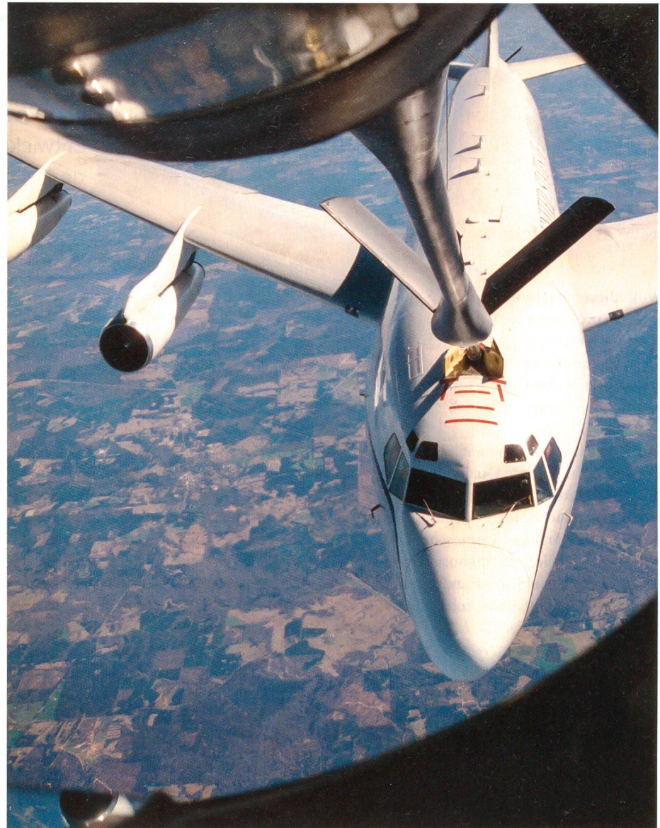
Hoch über den Südstaaten der USA wird ein Führungsflugzeug der USAF vom Typ EC-135 «Looking Glass» von einem Tankerflugzeug KC-10 mit Treibstoff versorgt. Die Aufnahme entstand in der Kanzel des Tankstutzen-Operators am Heck der KC-10.
