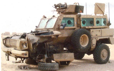
Fahrzeug des Typs RG-31 im Irak nach der Explosion einer Sprengladung – der Personenraum ist intakt geblieben.
