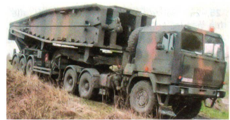
Polnische Unterstützungsbrücke des Herstellers «OBRUM».
