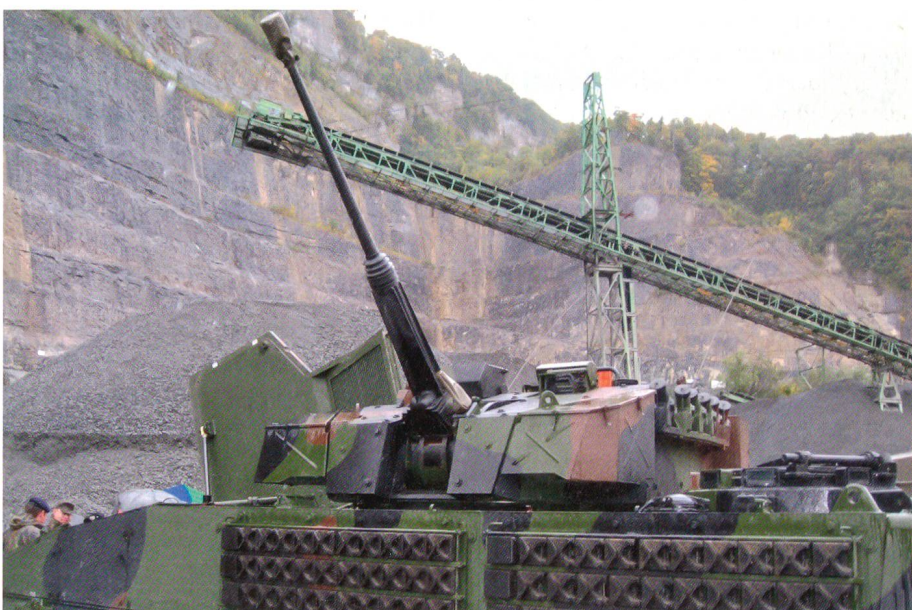
Der Schützenpanzer Ulan ist das Gefechtsfahrzeug der Panzergrenadiere. Er wiegt 28 Tonnen und führt elf Mann mit. Die Maschinenkanone hat das Kaliber 30 Millimeter.
