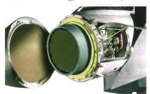
Die neuartige AESA-Antenne ermöglicht die simultane Ausführung von Radarfunktionen, Luftüberwachung, Luft-Boden-Übertragungen und Feuerleitung.
